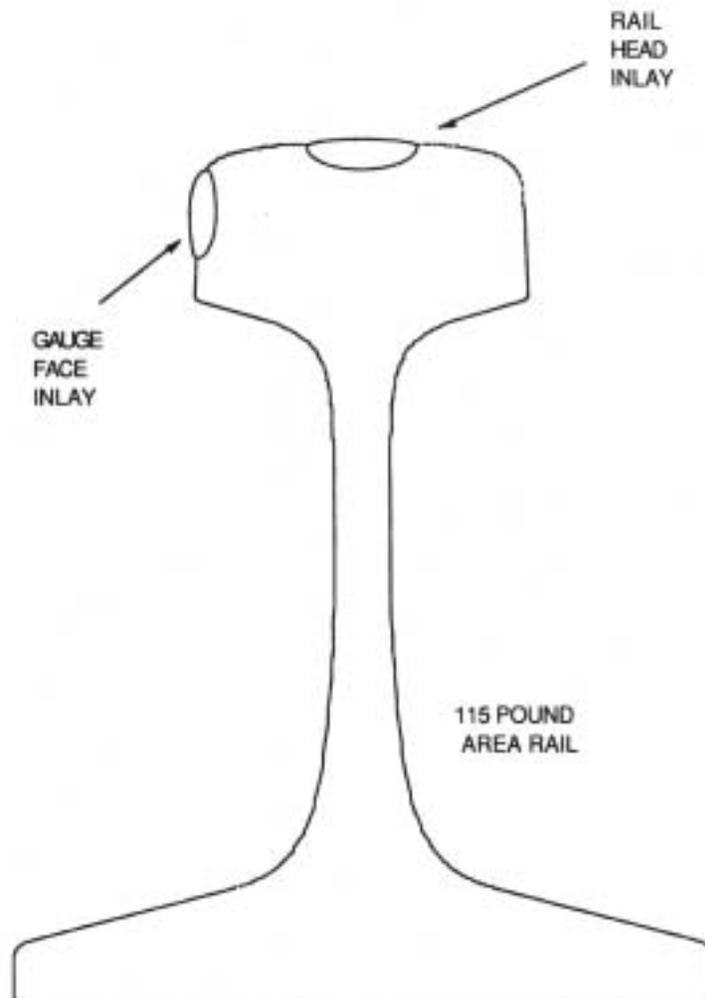
FIGURE 8-11 RAIL HARDFACING
