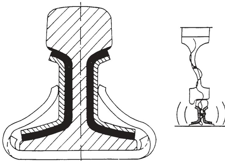
FIGURE 8-9 RAIL VIBRATION DAMPERS (PHOENIX AG TYPE 799323)
