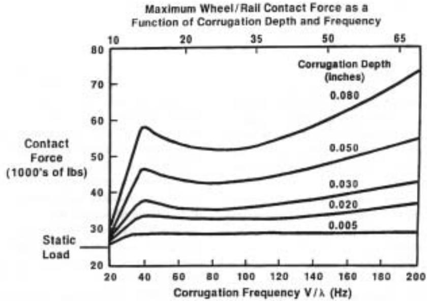
FIGURE 10-2 WHEEL/RAIL FORCE VERSUS CORRUGATION AMPLITUDE AND FREQUENCY
