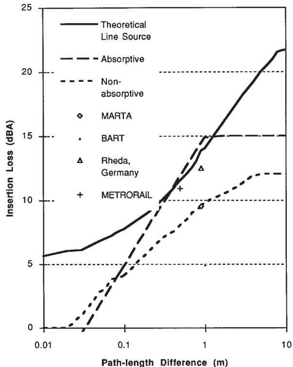
FIGURE 9-2 SOUND BARRIER INSERTION LOSS FOR RAIL TRANSIT SYSTEMS
